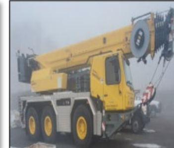
Grúa de terreno
